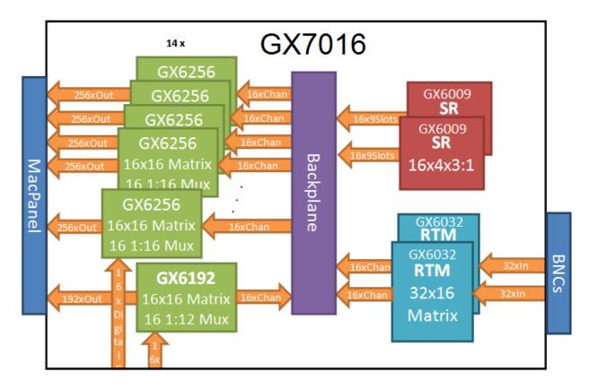
Figure 2-7: GX7016 Genasys Switching Sub-System Block Diagram
